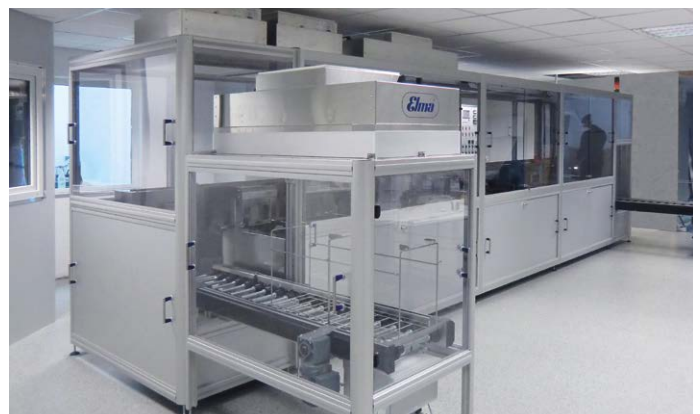
X-tra line mit Einhausung und Laminar-Flow um höhere Reinheitsanforderungen zu erfüllen, zur Lärmreduktion sowie als Schnittstelle zum Reinraum
